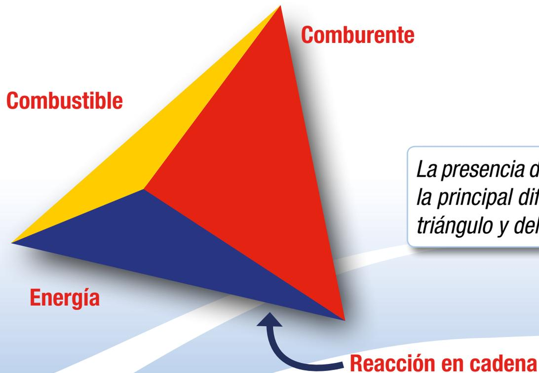
*La presencia de la reacción en cadena es la principal diferencia entre la teoría del triángulo y del tetraedro del fuego.*
