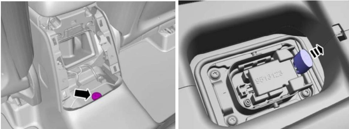
Siga las indicaciones relativas a batería de alta tensión, desconexión; retire la tapa del tapiz ubicada en la parte inferior, a los pies de la segunda fila de asientos al interior del habitáculo.
