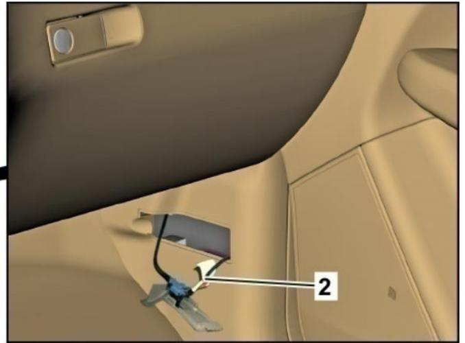
Retirar la cubierta (1) / cortar el cable por el lugar marcado (2)
