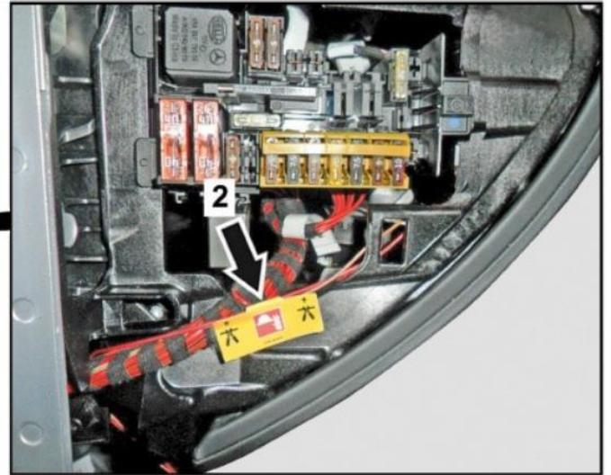
Retirar la cubierta (1) de la caja de fusibles / cortar el cable por el lugar marcado (2)
