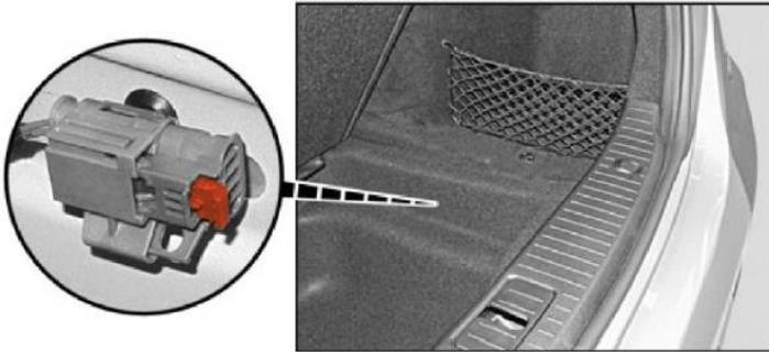
Dispositivo de desconexión de alto voltaje en el maletero
