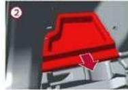
3. Localizar el fusible (debajo del soporte de plástico) y extraerlo.
