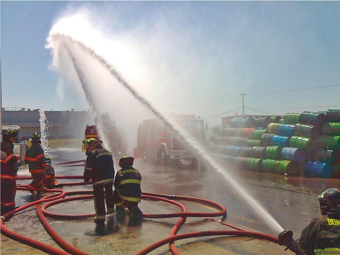
Aplicación de agua mediante monitor portátil a 30° de inclinación.
