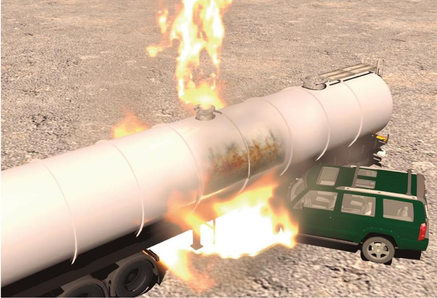
**FASE 4:** Generación de fisura que se propaga por el manto, permitiendo la violenta fuga de vapor desde el interior y gasificando casi todo el líquido contenido.
