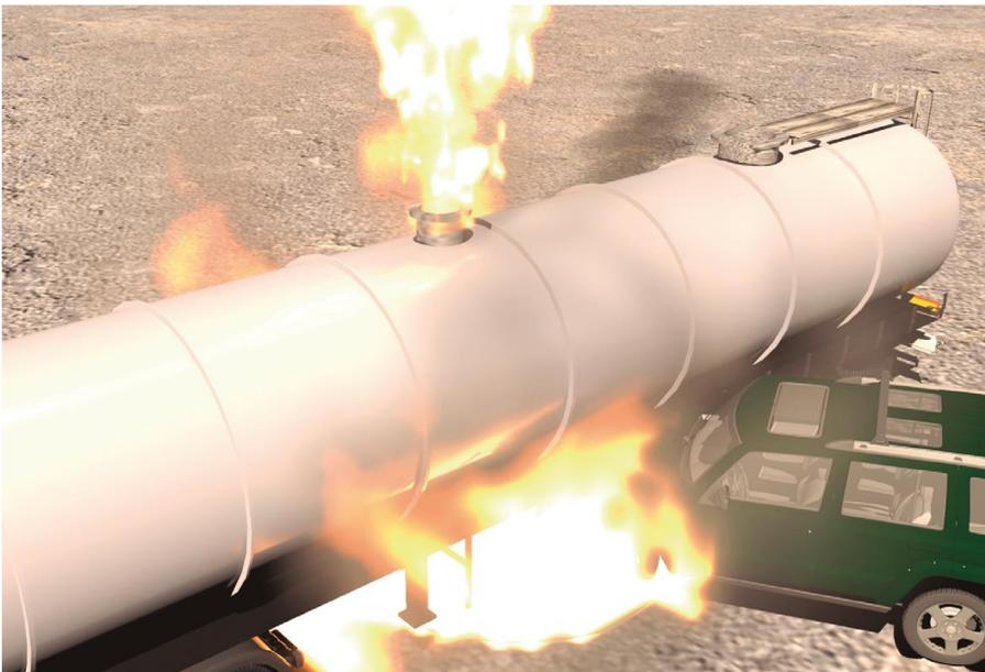
**FASE 3:** Cambio de coloración en el manto del estanque en la zona de contacto con las llamas, especialmente sobre la línea de flotación del líquido, el cual puede ir acompañado con la deformación de la superficie metálica.
