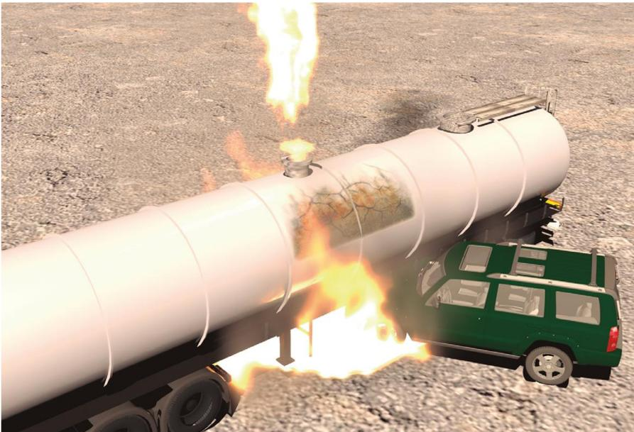
**FASE 5:** Inflamación de la nube de vapor en caso de ser un líquido inflamable, generación de onda expansiva con características explosivas y proyección de los pedazos del recipiente a una velocidad cercana a los 300 metros por segundo en todas direcciones.
