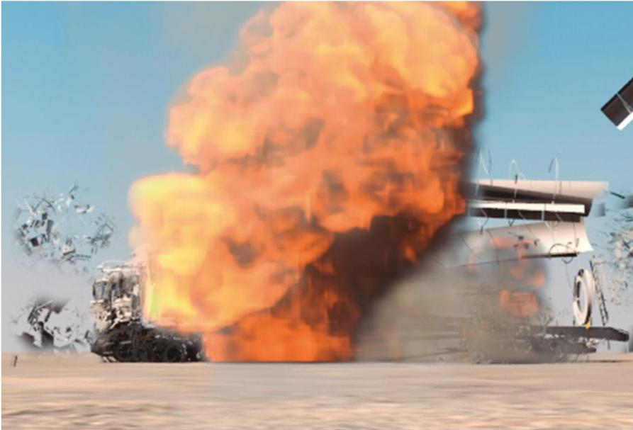
La rotura del recipiente se puede producir por una menor resistencia como resultado de una anomalía mecánica o por el calentamiento localizado por encima del nivel del líquido que debilita el acero al carbono de la mayoría de los recipientes.
