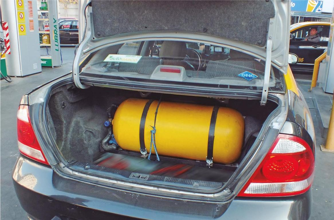
Gas natural comprimido en maletero de un vehículo.
