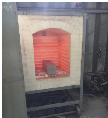
Figura 10. Elemento de viga sometido a ensayo de incendio
