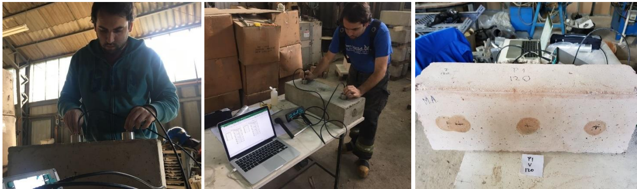
Figura 4. Ensayo de VPOU en viga
