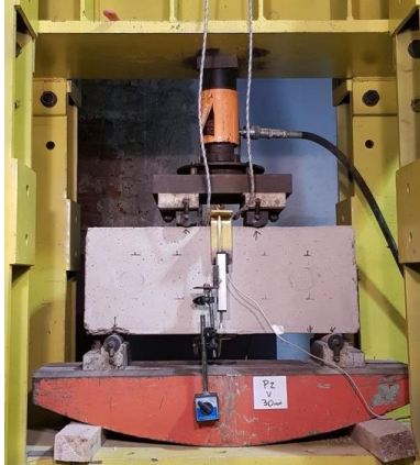
Figura 13. Implementación del ensayo de flexión en vigas de hormigón armado
