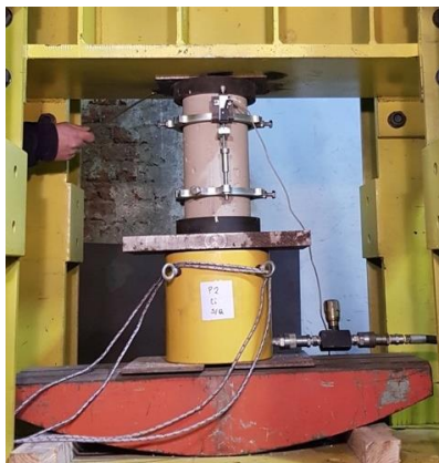
Figura 11. Implementación del ensayo de compresión en probetas cilíndricas de hormigón
