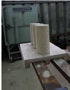
Figura 9. Grupo de probetas cilíndricas de hormigón sometidas a ensayo de incendio
