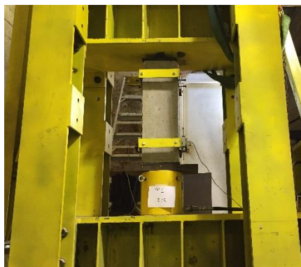
Figura 14. Implementación del ensayo de compresión en columnas
