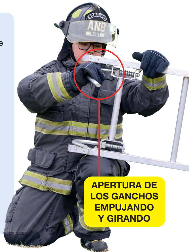
APOYO DE ESCALAS EN PUNTOS FIRMES DE LA ESTRUCTURA
