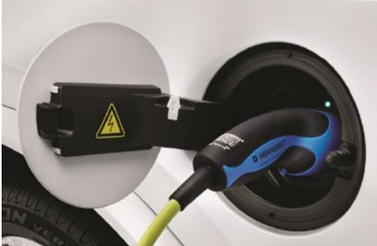
Existe señalética en zonas del vehículo las cuales advierten de la presencia de alta tensión, como ejemplo la tapa de conexión eléctrica
