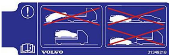
No se permite remolcar el XC90 II T8. Durante el remolcado del vehículo, deberá desplazarse la menor distancia posible, a una velocidad máxima de 10 km/h según la carga. Ninguna de las ruedas puede estar en contacto con el suelo durante el remolcado. De esta forma, se evita dañar la caja de cambios y el motor eléctrico. El ojal de remolcado puede utilizarse para tirar del vehículo y colocarlo en la plataforma del vehículo de recuperación.
