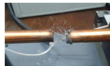
Detalle de los electrodos y de la lana de acero utilizada para activar el arco.
