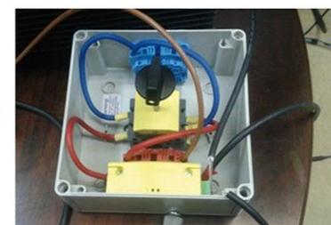
Imagen del detector de arcos ensayado ubicado en la caja de protección IP65, donde se incluye un interruptor manual de corriente continua (32A/1000V).
