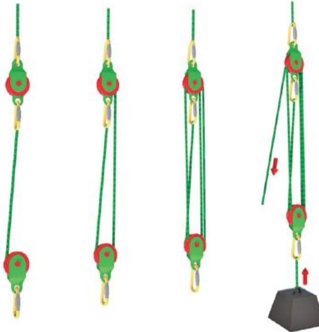
Figura N° 2. Utilización de poleas para multiplicación de la fuerza
