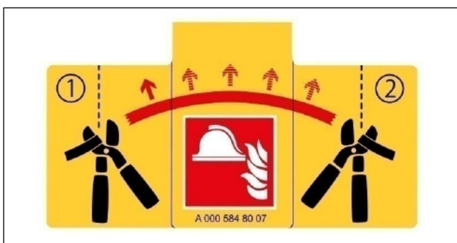
Rótulo indicativo del preequipo alternativo de desconexión de alto voltaje
