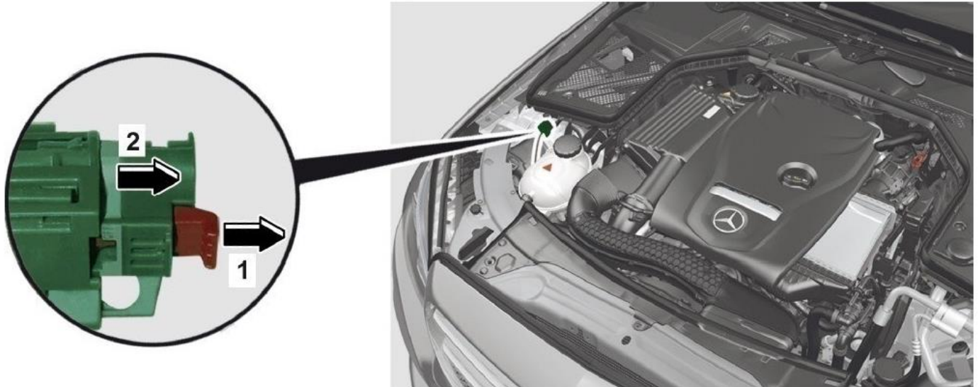
Dispositivo de desconexión de alto voltaje en el vano motor, Accionar el desbloqueo (1) / extraer el interruptor (2)
