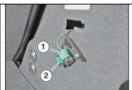
Atención: El interruptor de seguridad de alto voltaje no se puede separar completamente.
