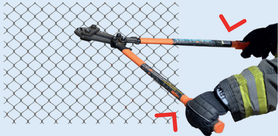
FORZADO DE MALLAS METÁLICAS
