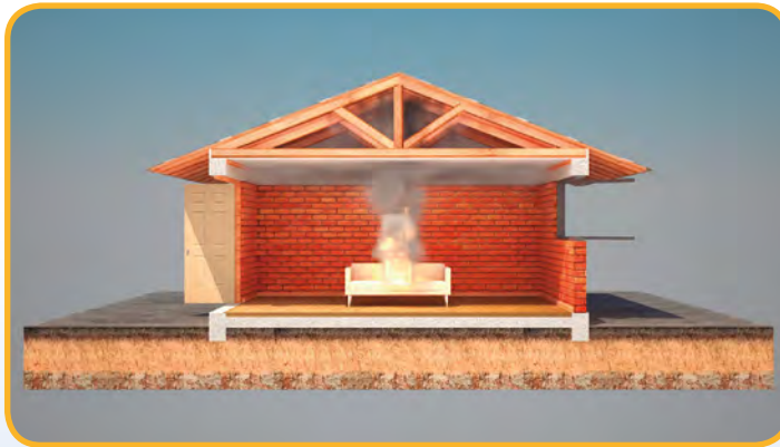
Fase inicial o encendido
