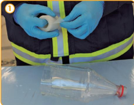
1 Cortar la base y proteger los bordes del embudo resultante con cinta adhesiva.
