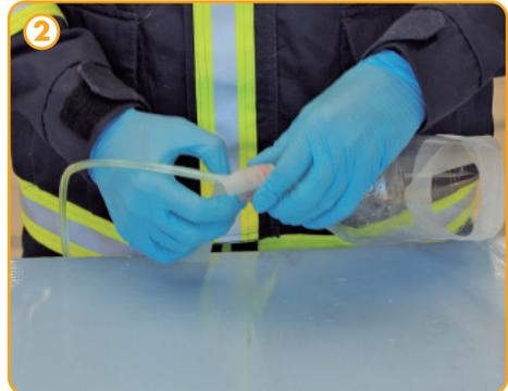
2 Fijar la sonda de oxígeno a la salida estrecha del embudo con cinta adhesiva.
