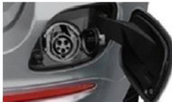
② Caja de enchufe de carga de alto voltaje
