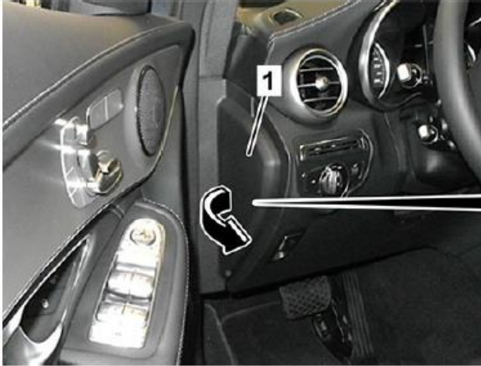
Retirar la cubierta (1) / cortar el cable por el lugar marcado (2)
