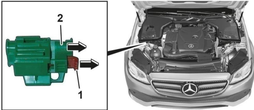
Dispositivo de desconexión de alto voltaje en el vano motor
