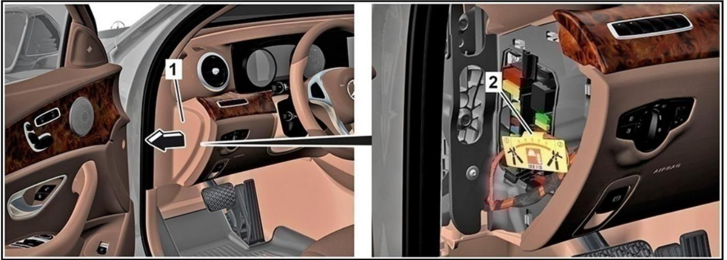
Retirar la cubierta (1) de la caja de fusibles / cortar el cable por el lugar marcado (2)
