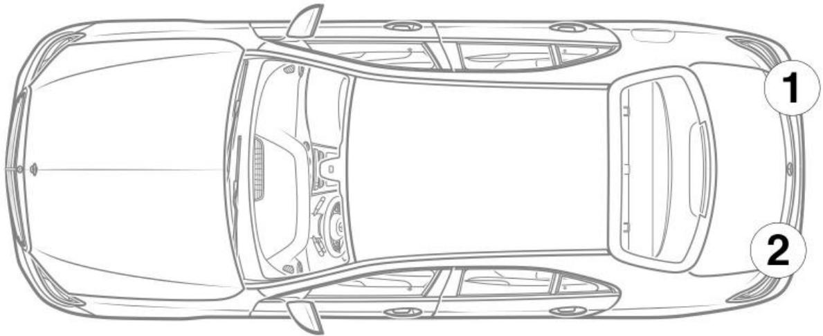
① Caja de enchufe de carga de alto voltaje
