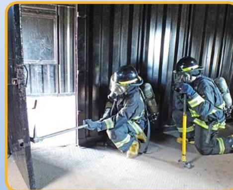
Para la misma técnica, puede alternar cambiando la posición del *halligan*, usando la horquilla o pata de cabra.
