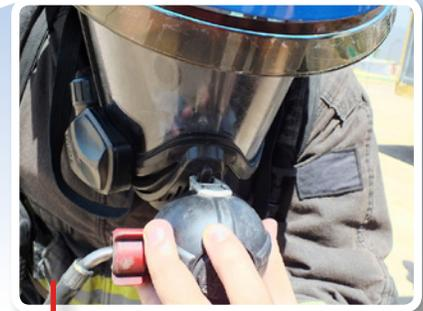
Módulo Control (indica presión de cilindro).
