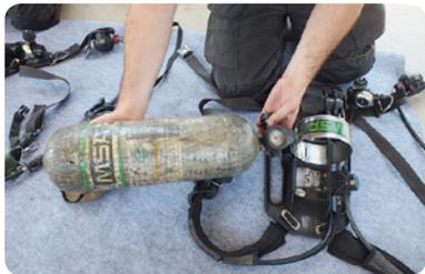
Debe revisar todos los componentes del ERA y verificar su integridad y funcionamiento antes de considerarlo óptimo para su uso. Cilindro debe estar lleno (FULL).
