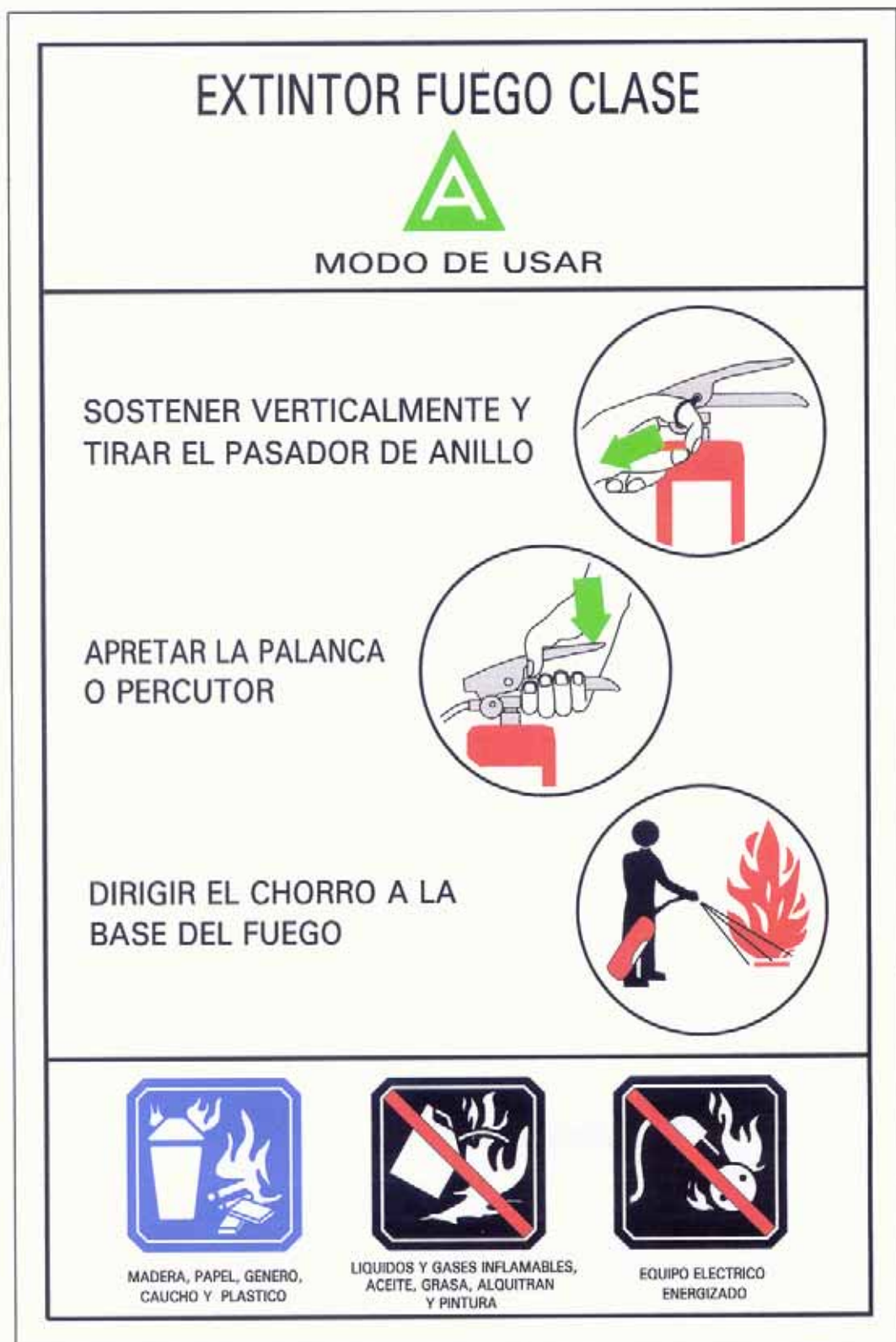
Figura B.1 - Ejemplo de etiqueta con instrucciones de uso para extintor de fuego Clase A
